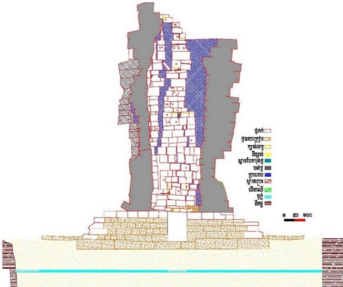
រូបលេខ៤៧ គំនូរបង្ហាញពីដីឥដ្ឋត្រូវបានជួសជុល: បង្ហាញពីសម្ភារនិងបច្ចេកទេសរៀបចំគ្រឹះ
